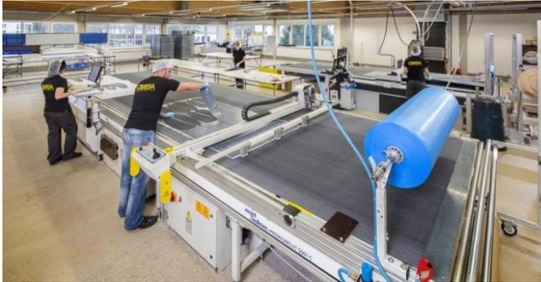
Cutter für Teile bis zu 8 m x 2 m
